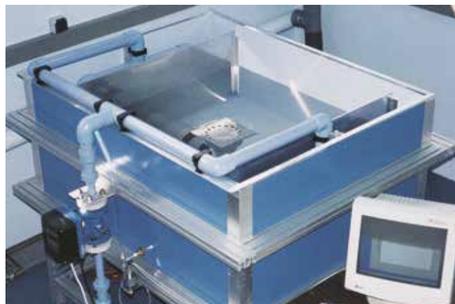
Prova di evacuazione su un chiusino sifonato .
