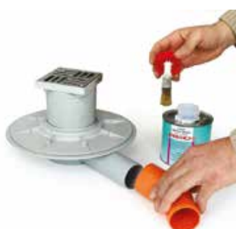
Chiusino sifonato a secco orizzontale può essere incollato su PVC o innestato su PP.
