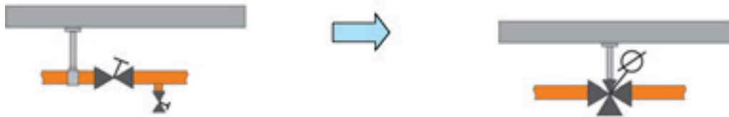
Классическая схема: запорный и сливной клапаны
