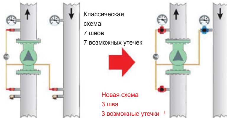
Классическая схема: запорный и сливной клапаны
